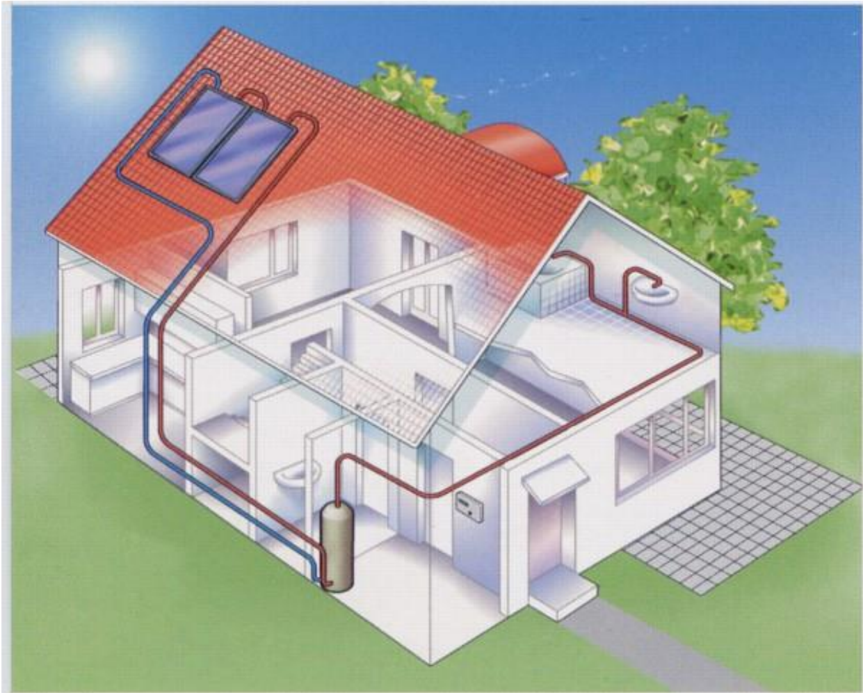
(Schema di collegamento dell'impianto solare termico con la caldaia a gas istantanea)
